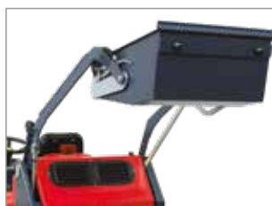
SISTEMA DI SCARICO CON PISTONE IDRAULICO
