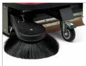
RUOTINO FRONTALE DOTATO DI FRENO PER PARCHEGGIO
